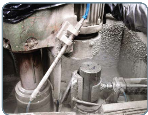
Retífica utilizada para o corte superficial do topo do corpo-de-prova
