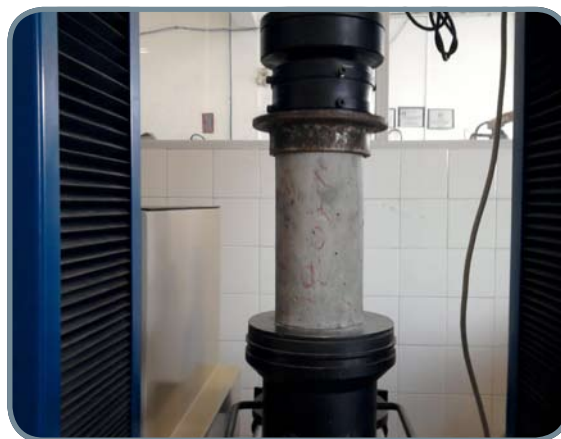
Detalhe do corpo-de-prova faceado no topo superior com borracha e capacete metálico
