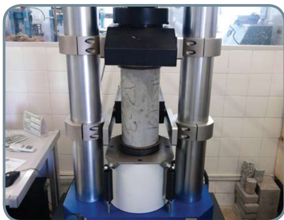
Amostra preparada para ruptura na prensa hidráulica
