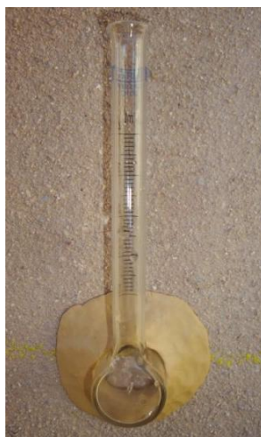
Figura 08 – Ensaio de permeabilidade com o cachimbo
