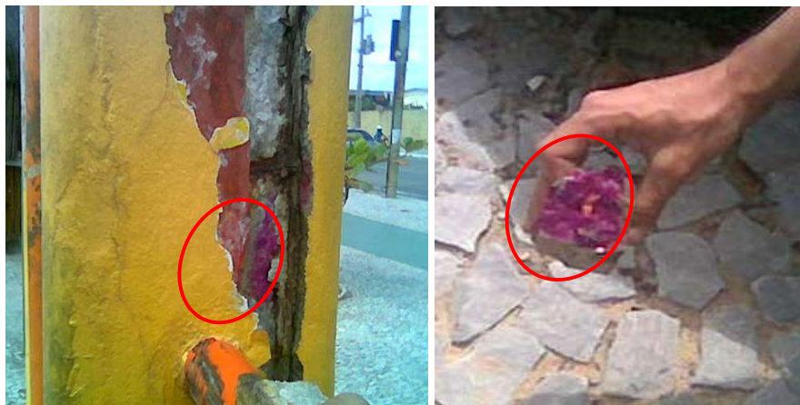
Figura 4. Ensaio de carbonatação com a utilização de solução de fenolftaleína nas barras para exercícios e banco
