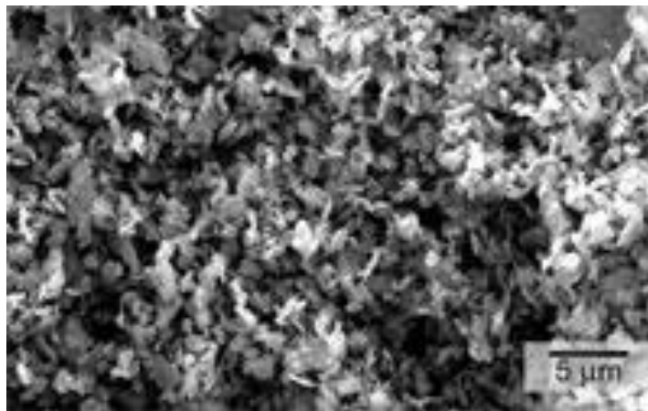
Figura 02 – Metacaulim – Microscopia Eletrônica – ampliado 3000 X (fonte o fabricante)
